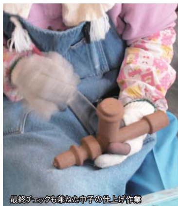
最終チェックも兼ねた中子の仕上げ作業
